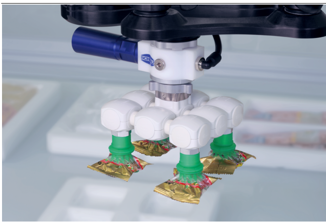
Ventosas de fuelle SPB2f durante la manipulación de bolsas
